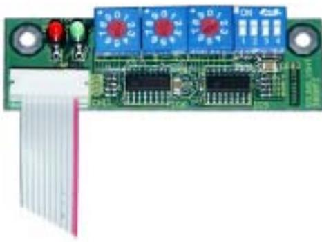
Ein Codierschalterboard ist bei Geräten zur Schaltschrankmontage nicht im Lieferumfang enthalten. Es wird nur zur einmaligen Programmierung benötigt. Sie können ein Startadressboard 3000P (mit Schaltern) oder 3003P (mit LED Display) verwenden.
